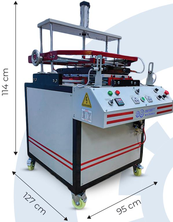
تقوم هذه الماكينة بعمل الكارت الخاص بتغليف اي منتج عن طريق تسخين الجوانب الثلاثة للكارت لعدده ثواني ثم ثني الجوانب ثم تبريدها عن طريق الهواء
