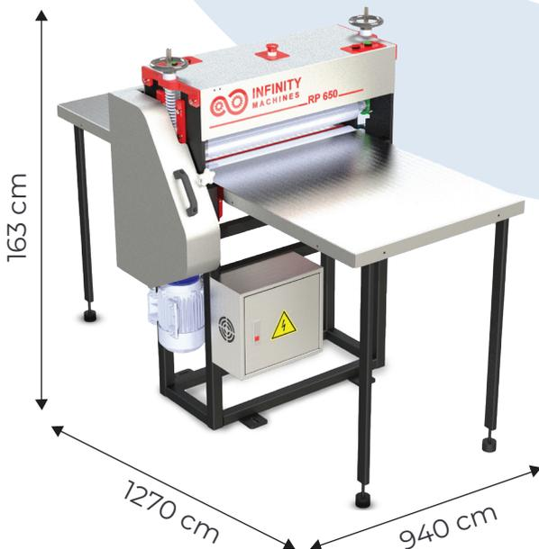
تقوم هذه الماكينة بقص القطع المُشكَّلة طبقاً لشكل اسطمبة التقطيع لتفريغ قطع صغيرة مُشكَّلة من قالب الكبير تتسم هذه الماكينة بالإنتاجية وسهولة التعامل .
